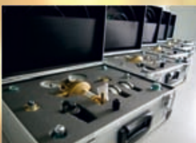
Zestawy walizkowe do diagnostyki, kalibracji oraz ładowania azotem akumulatorów hydraulicznych
